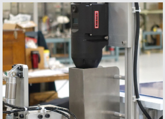
Leister MISTRAL Gebläse installiert in einer Produktionsstrasse.
