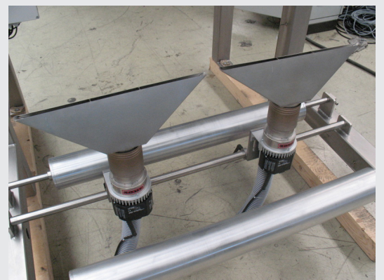
2 der 4 LHS 61L SYSTEM Lufterhitzer mit Breitschlitzdüsen
